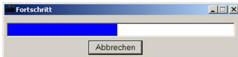
Nach Beendigung der Übertragung fragt das Programm, ob das geladene Programm sofort initialisiert und gestartet werden soll. Wird dieser Dialog mit "Nein" bestätigt, so wird das geladene Programm erst nach dem nächsten Geräte-Neustart aktiviert!
