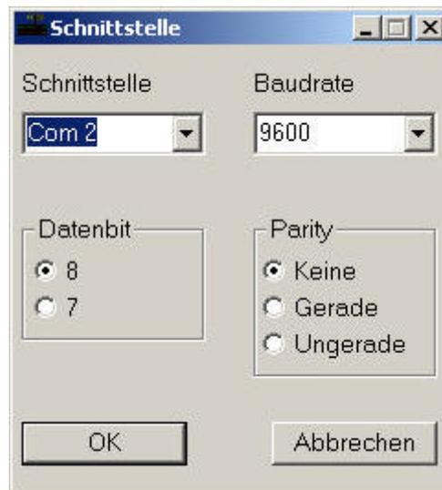
Unter "Schnittstelle" ist die serielle Schnittstelle auszuwählen, an der das Gerät an den PC angeschlossen ist. Baudrate, Datenbit und Parität sind so auszuwählen, dass diese den Einstellungen des Zielgerätes entsprechen.
